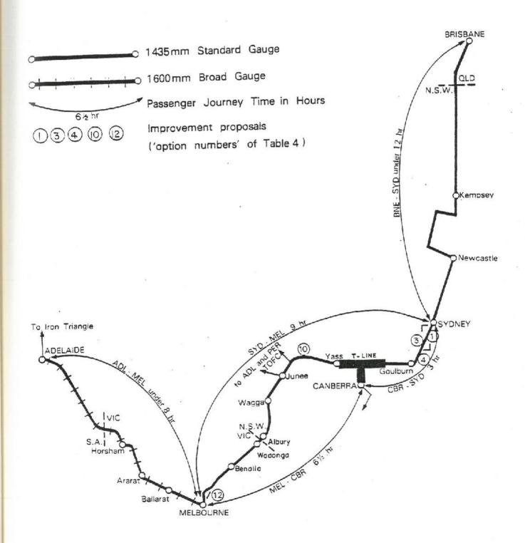
FIG. 2 BICENTENNIAL HIGH - SPEED RAILWAY PROJECT
